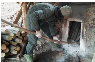
材の建て込み
